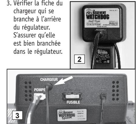
Le régulateur doit obligatoirement être alimenté par une prise de courant 115 V CA +/- 5%. Une tension inférieure à 110 V déclenche l'alarme « POWER ». Une sous-tension peut être causée par une baisse de tension au niveau de la compagnie d'électricité, ou par une forte consommation d'autres appareils branchés sur le même circuit. Diminuer le nombre d'appareils branchés sur le circuit.
