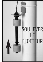
Pendant le fonctionnement des pompes, de l'eau sort du trou de 3 mm (1/8 po) situé en haut de la pompe principale, et du trou percé dans le coude de la pompe de secours. C'est normal. Ces trous sont destinés à empêcher les poches d'air dans le circuit. Ces trous **NE DOIVENT PAS ÊTRE OBSTRUÉS**, ce qui causerait alors une poche d'air empêchant le fonctionnement du circuit.
