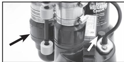
de la pompe de secours. Ce phénomène est normal. Les trous sont nécessaires pour éviter un blocage d'air dans le système. N'obstruez **PAS** les trous pour éviter un blocage d'air dans le système.
