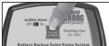
Pendant une panne de courant, ou quand la pompe se déclenche fréquemment, on peut arrêter l'alarme provisoirement en mettant l'interrupteur « Audible Alarm » sur « OFF ». **Après le retour en service de la pompe primaire, et la fin des déclenchements à répétition de la pompe de secours, remettre l'interrupteur sur la position « ON » pour rétablir la surveillance.** Le voyant d'alarme et le voyant « PUMP » restent allumés. Appuyer sur le bouton Reset du panneau de commande pour arrêter l'alarme.
