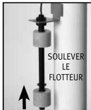
pour arrêter l'alarme. En cas d'appui sur le bouton Reset avant l'arrêt de la pompe, l'alarme retentit temporairement. Attendre l'arrêt de la pompe avant d'appuyer sur le bouton Reset pour arrêter complètement l'alarme.
