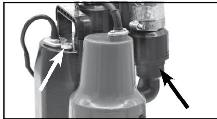
Pendant que les pompes fonctionnent, l'eau sortira par le trou de 1/8 po (3,1 mm) situé sur le dessus de la pompe primaire, et par le trou de 3/16 po (4,7 mm) situé dans le coude de la pompe de secours. C'est normal. Ces trous sont destinés à empêcher une poche d'air dans le circuit. Ces trous NE DOIVENT PAS ÊTRE OBSTRUÉS, ce qui causerait alors une poche d'air empêchant le fonctionnement du circuit.
