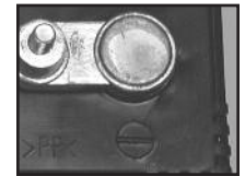
La BORNE NÉGATIVE (-) a un diamètre plus petit
